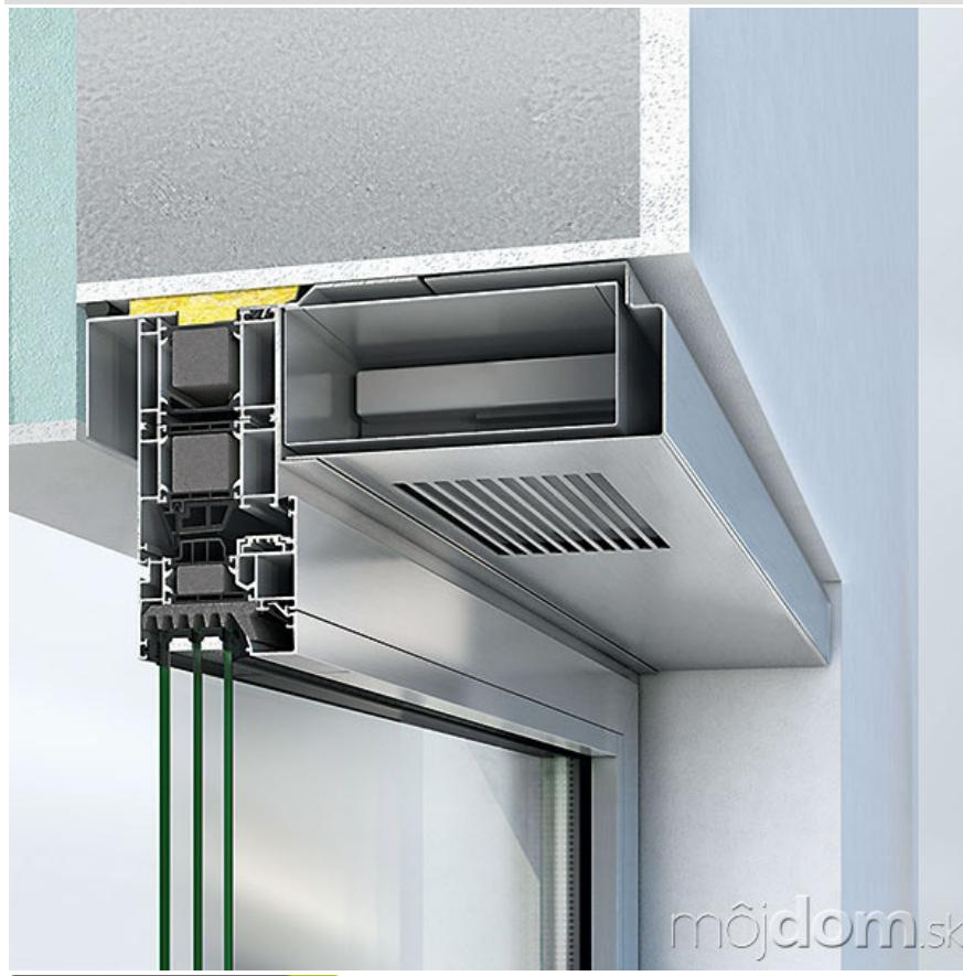
**Ďalších 9 fotografií v galérii** Izované vetranie predstavuje SchücoVentoTherm. Ide o vetranie s rekuperáciou tepla bez otvorenia okna integrované do okenného rámu. Zabezpečujú sa ním optimalizácia spotreby energie (systém znížuje energetické straty spôsobené odvetrávaním až o 35 %), interiérovej klimy a kvality vzduchu (obsahuje pefový filter). Zapínanie a vypínanie systému a tiež volba intenzity vetrania sa deje prostredníctvom ovládača integrovaného do rámu okna.
